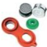
**Durchflussbegrenzer und Perlatoren** senken die Wassermenge. Durch die beigemengte Luft kommt ein voller Strahl zustande. Ein Kunststoffschlüssel erleichtert das Wechseln und schont das Chrom der Armatur. Bei Wasser-Entnahme-Stellen, wo schnell ein Eimer gefüllt werden soll oder zur Gartenbewässerung, sind solche Begrenzer nicht zu verwenden, da ein schnelles Befüllen und ein hoher Wasserdurchlauf erwünscht ist.
